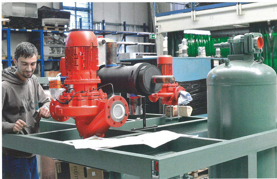
In der Werkhalle erfolgt unter anderem die Montage von Kaltwassersätzen mit Schraubverdichtern zur Erzeugung von Kaltwasser in Bananenreifereien. Frigotec und EHW haben insgesamt 40 Mitarbeiter.
